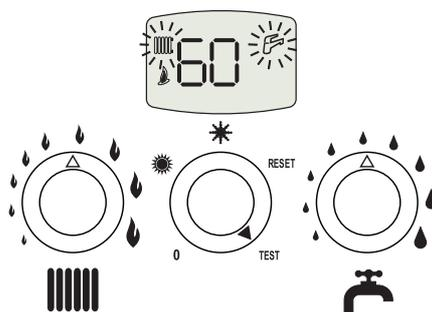
fig. 21 - Modalità TEST (potenza riscaldamento = 100%)
