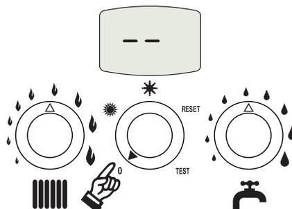
fig. 7 - Spegnimento caldaia
