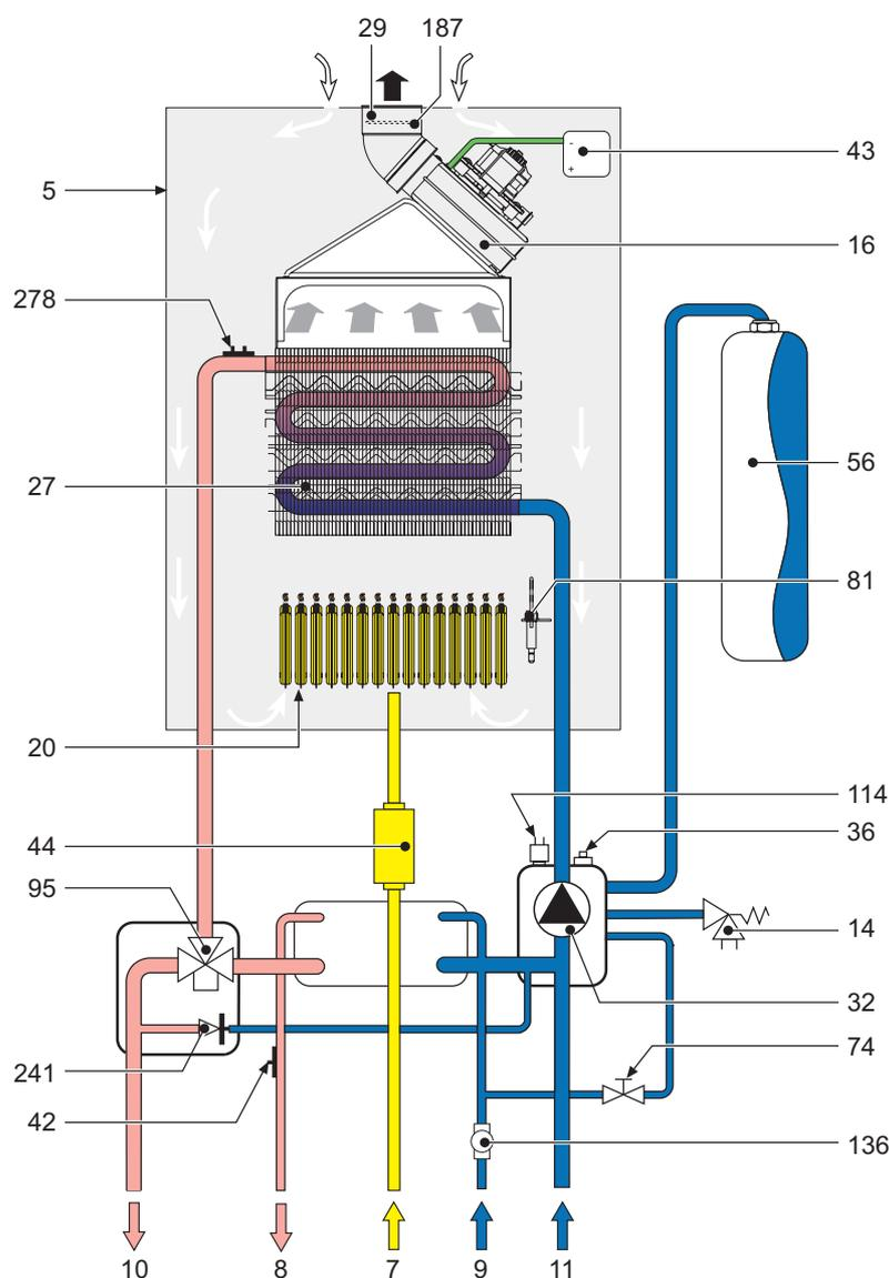
fig. 25 - Circuito idraulico
